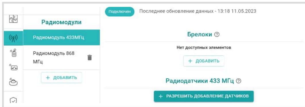
При этом отображается индикатор готовности к добавлению датчиков
