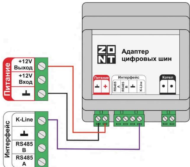
**Примечание:** Полярность подключения к цифровой шине котла значения не имеет.
