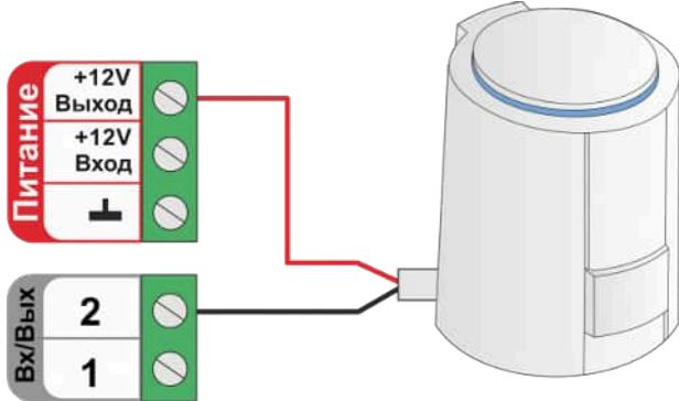
Схема подключения к релейному выходу:
