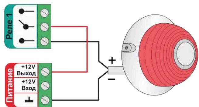
Для подключения **светозвуковых оповещателей** используются уже два выхода контроллера.
