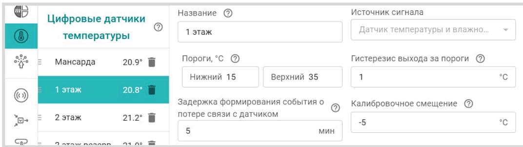
Датчик температуры и влажности МЛ-779 определяется автоматически только как датчик температуры. Для контроля влажности, датчик должен быть выбран вручную на вкладке “Датчики”. При этом необходимо указать в параметре “Номер аппаратного входа” – “Датчик температуры и влажности”
