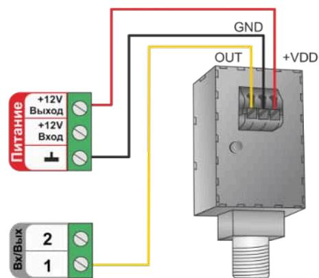
**Примечание:** Тип сенсора входа Контроллера, выбранного для контроля давления должен соответствовать модели подключаемого датчика или указан как “аналоговый вход”.
