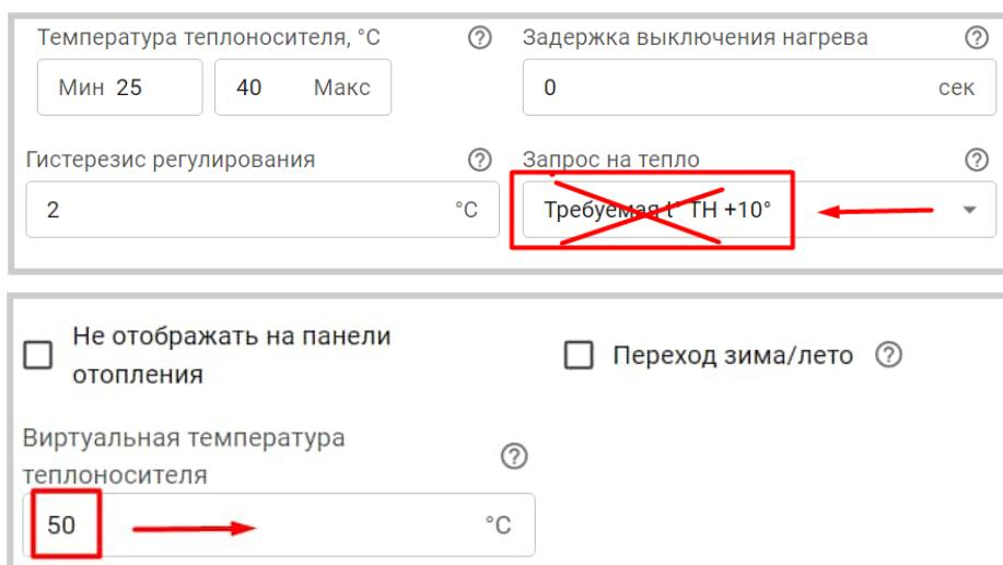
**Примечание:** Если в контуре включено управление с учетом ПЗА, то значение “запроса на тепло” определяется по выбранной кривой ПЗА. Описание работы ПЗА приведено [Части 2, Раздел 12 Погодозависимое регулирование \(ПЗА\)](#).
