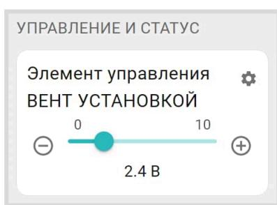
**Примечание:** Если аналоговый выход 0-10В управляет Исполнительным устройством используемом в котловом или отопительном контуре, то перемещение движка вручную изменит напряжение на выходе, но оно не сохранится, т.к. алгоритм управления отоплением вернет напряжение в то значение, которое необходимо по алгоритму.
