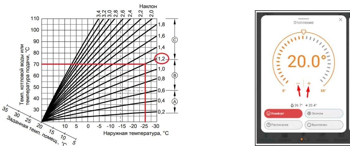
Если в процессе эксплуатации возникает необходимость применения другой кривой ПЗА, то для этого достаточно изменить целевую температуру воздуха в панели этого контура отопления в большую или меньшую сторону относительно предустановленных **20°C**.
