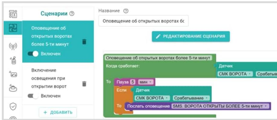
Сценарий имеет приоритет второго уровня, что означает невозможность его выполнения, если команды и операции противоречат логике автоматического управления котлом и приборами системы отопления при выполнении задач действующего режима отопления согласно конфигурации Контроллера.
