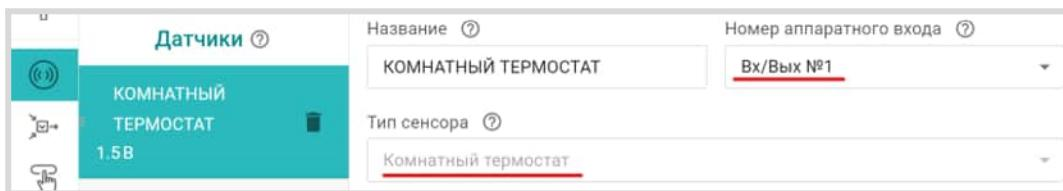
В настройке такого контура указать, что сигнал термостата управляет **Активностью контура**
