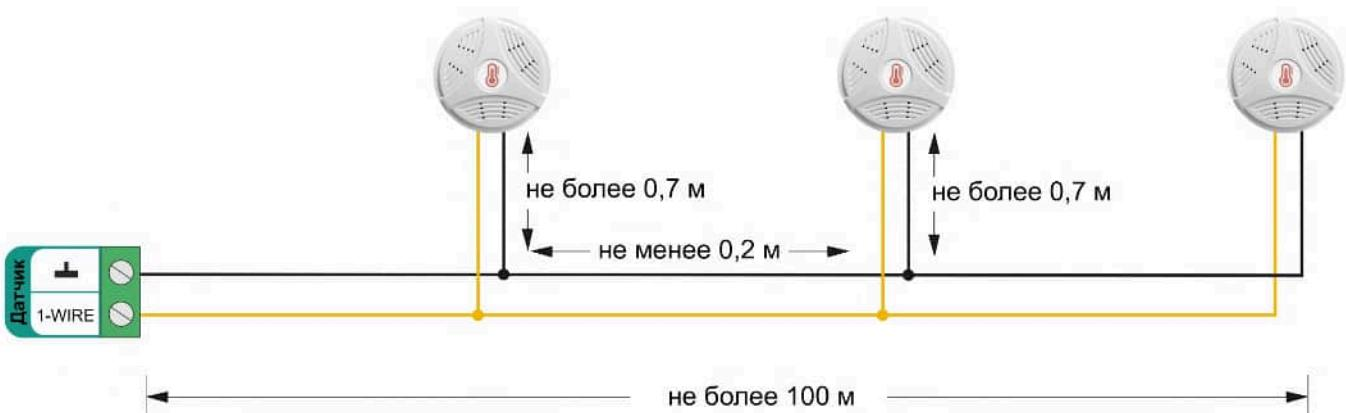
Подключение датчиков по трехпроводной схеме:
