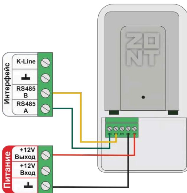
Схема подключения радиомодуля по K-Line:
