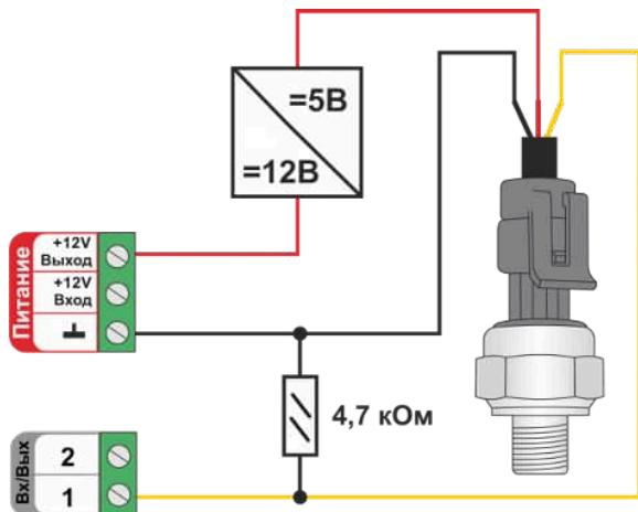
**Датчик давления MLD-06 (снят с производства):**
