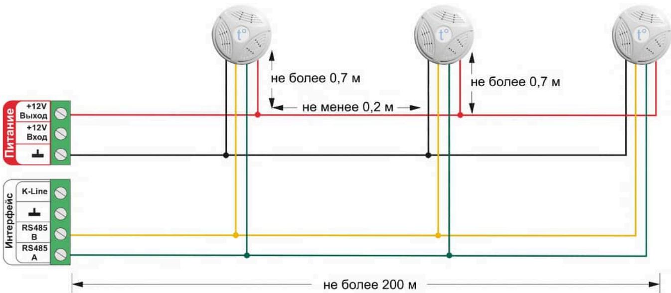
Подключение нескольких датчиков по K-Line:
